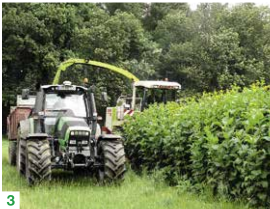
1 Optimal ist eine Bestandesdichte von 2 bis 3 Pflanzen/m 2 . 2 Weil das Pflanzen arbeitsintensiv ist, wird an einer Drillsaat geforscht. 3 Die Ernte erfolgt mit einem Maishäcksler.
